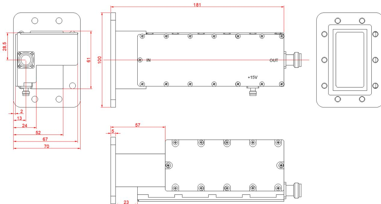
航达微电子推出的 Surp@ss 系列产品 C 波段抗 5G 干扰波导滤波器，可为卫星 C 波段接收链路提供优异的 5G 干扰信号抑制能力。支持标准 C 波段或扩展频段，具备优异的防水能力。体积小、重量轻，可广泛适用于各种复杂的干扰环境和安装环境。
